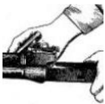
**9. Отделить газовую трубку со ствольной накладкой.** Удерживая автомат левой рукой, правой рукой повернуть замыкатель от себя до вертикального положения и снять газовую трубку с патрубка газовой камеры.
