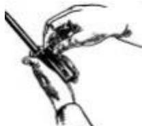
**8. Отсоединить затвор от затворной рамы.** Взять затворную раму с затвором в левую руку затвором кверху; правой рукой отвести затвор назад, повернуть его так, чтобы ведущий выступ затвора вышел из фигурного выреза затворной рамы, и вывести затвор вперед.
